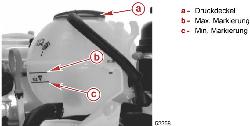
**WICHTIG: Der Kühlmittelstand wird von einem Sensor überwacht. Bei niedrigem Kühlmittelstand wird der Fehler erfasst, auf einem SmartCraft-Messgerät angezeigt und ein Warnsignal wird ausgegeben.**
